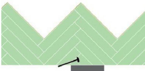
Posizionare un blocco sotto il materiale sul lato della linea di gesso per mantenere le tavole in posizione durante l'installazione. Picchiettare delicatamente il lato in eccesso con un martello per liberare o allineare il materiale.
