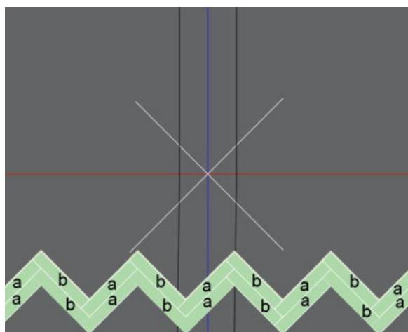
Una volta posate le tavole (a), procedere con l'installazione delle tavole (b) sull'intera larghezza del motivo a spina di pesce.
